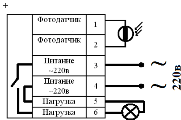
Рис. 3. Типовая схема подключения фотореле к сети 220в.
