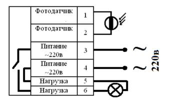
Рис. 2. Типовая схема подключения фотореле к сети 220в.
