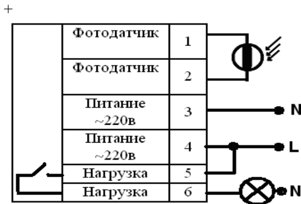
Рис. 2. Схема сборки фотодатчика.
