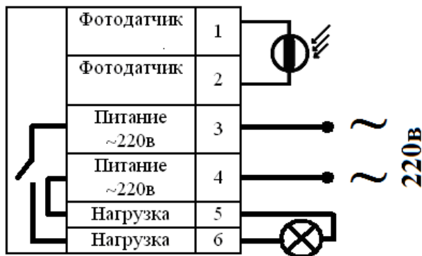
Рис. 2. Схема сборки фотодатчика.
