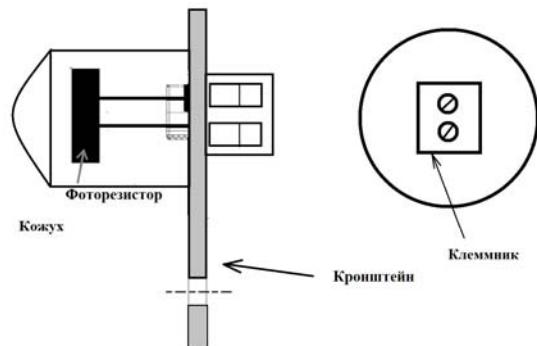
Рис. 1. Схема сборки фотодатчика.
