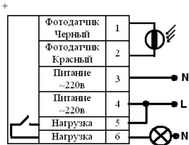
Рис. 1. Типовая схема подключения фотореле к сети 220в.
